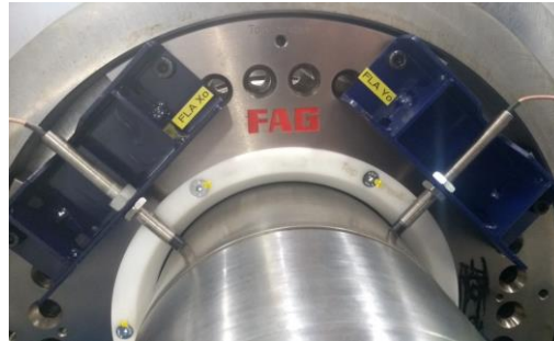
Abb. 4-13 Am MFLP montiertes Gleitfanglager und diversitäres Wellenlagemesssystem für Fanglager-versuche
