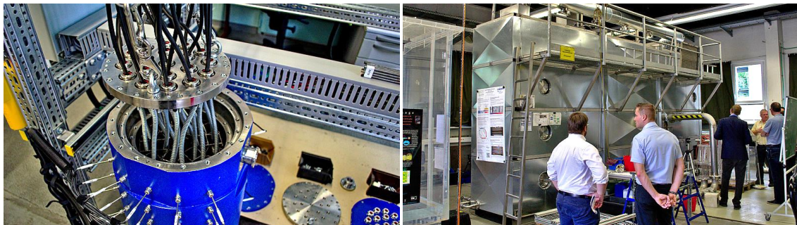
Abb. 4-36 Versuchsanlage „Thermographie“ und „Schwingungsanalyse“ (links); Besichtigung des IPM-Labors für Thermohydraulik (rechts)
