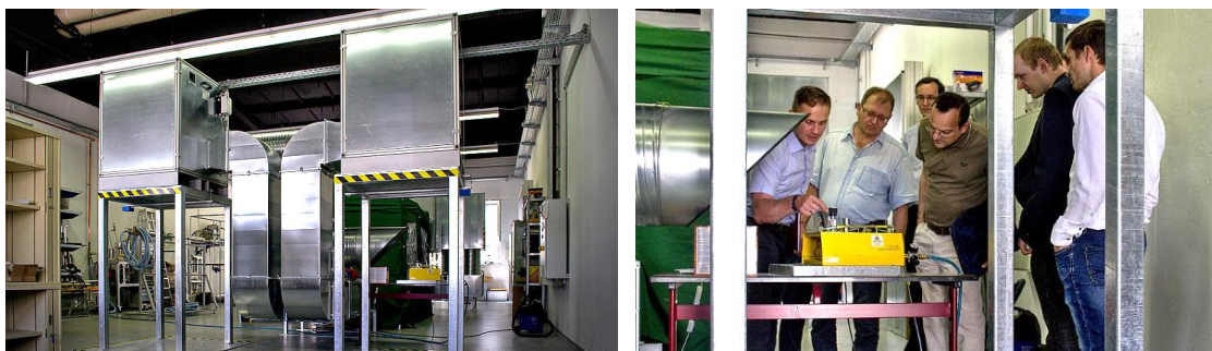
Abb. 4-35 Modellversuchsanlage „Fortluftkanal“ mit zwei Lüfterkästen im oberen Bereich (links); Erklärung der Funktionsweise des Partikelgenerators der Versuchsanlage (rechts)
