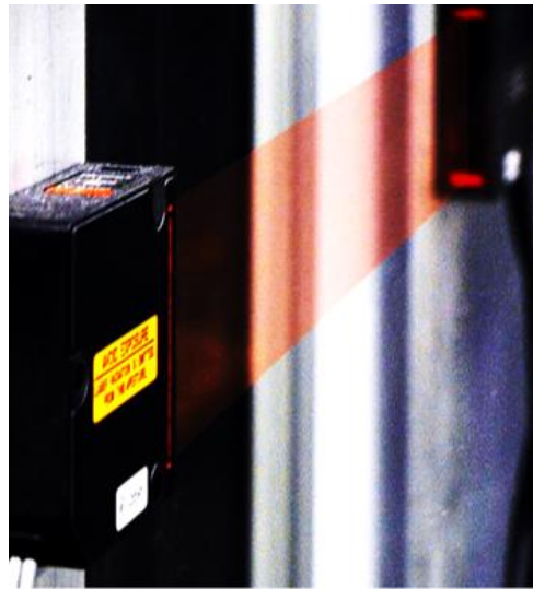
Abb. 4-10 Kompaktes Mehrkamarasystem für den Einsatz in Forschung und Industrie (links), Lasersensoren für Trübungsmessung in flüssigen Medien und Objektvermessungen (rechts)
