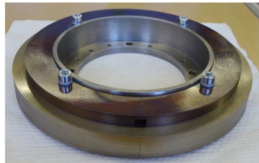
Abb. 4-12 Stator und Rotor des entwickelten Hochtemperatur-Lagesensors
