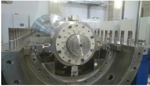
Abb. 4-13 Am MFLP montiertes Gleitfanglager und diversitäres Wellenlagemesssystem für Fanglager-versuche
