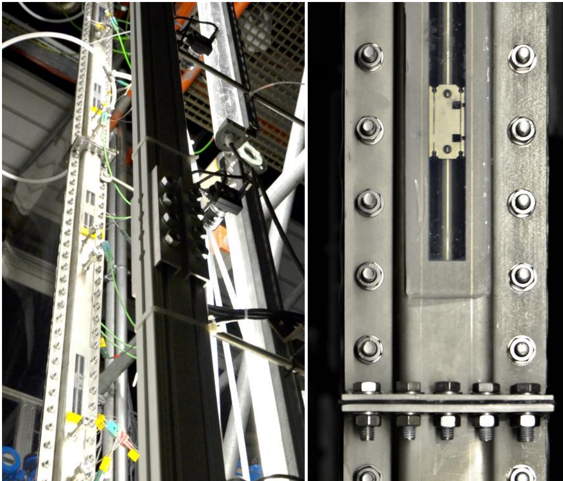
Abb. 4-8 Versuchsstandskomponente CORVUS (links); Edelstahl-Gehäuse mit 3x3-Heizstabkonfiguration in originaler Brennstablänge (rechts)
