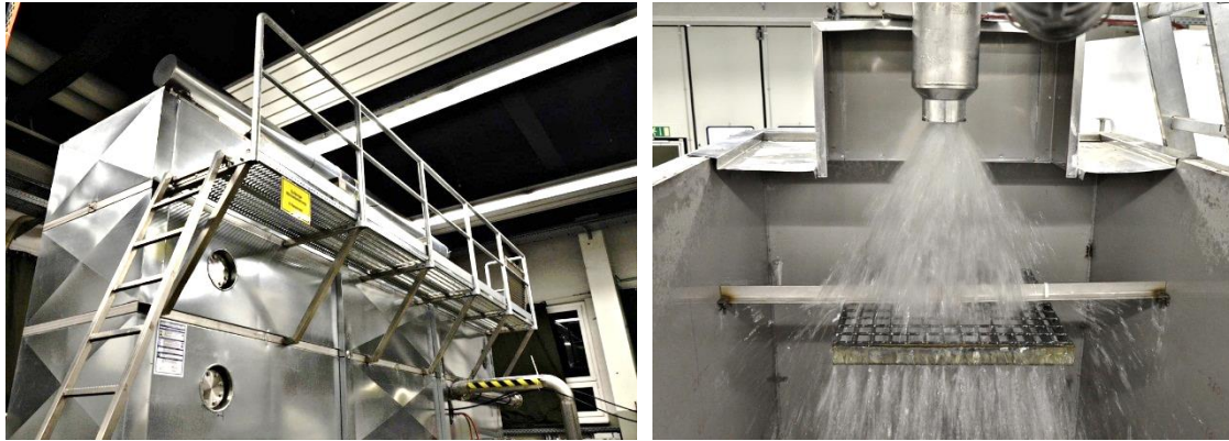
Abb. 4-4 Der Wannenbehälter der Zittauer Strömungswanne (ZSW; links); Korrosionsuntersuchungen an verzinkten Metallteilen in einem simulierten Leckstrahl (rechts)
