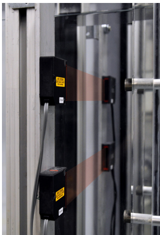
Einsatz der Lasersensoren am Versuchsstand „Ringkanal“ Application of laser sensors at test rig „Ring Channel“
