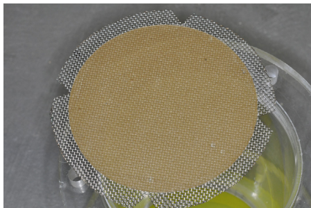
Durch Filtration an der Rückhaltevorrichtung entstandener Filterkuchen Filter cake caused by filtration through the retention system
