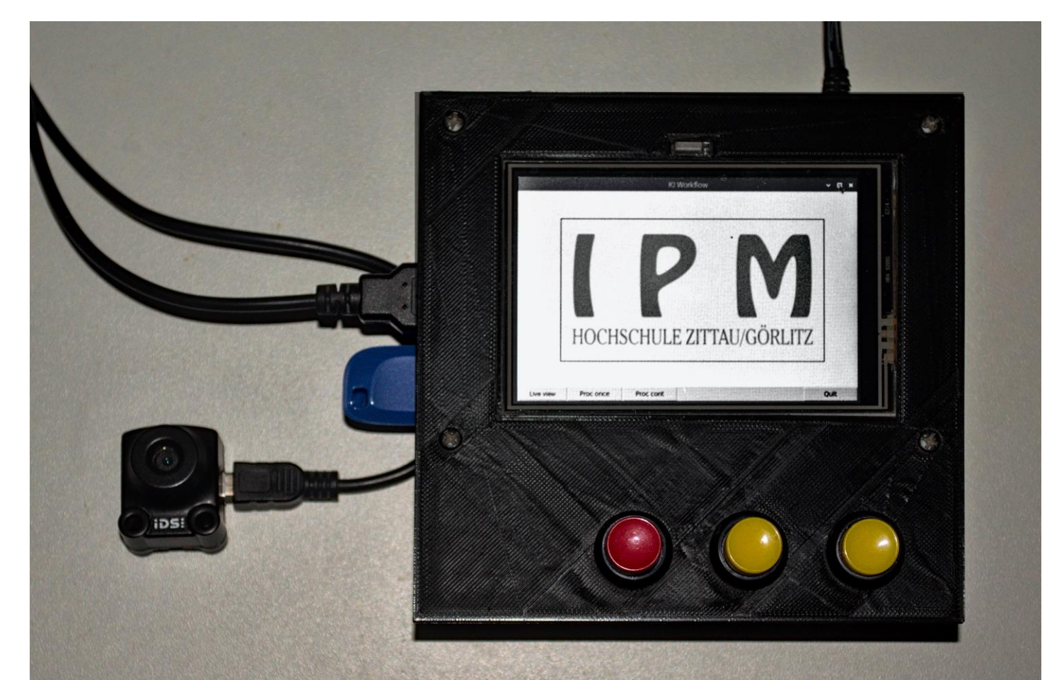
Versuchsaufbau mit Raspberry Pi 4 B, Touchscreen, Bedienfeld und USB-Kamera
