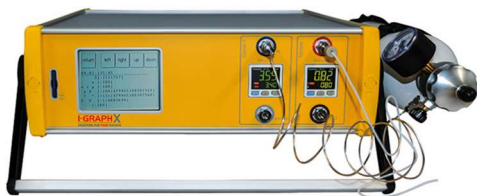
Abb. 2-21 Mikro-Gaschromatograph I-GRAPH XS der Firma INRAG AG
