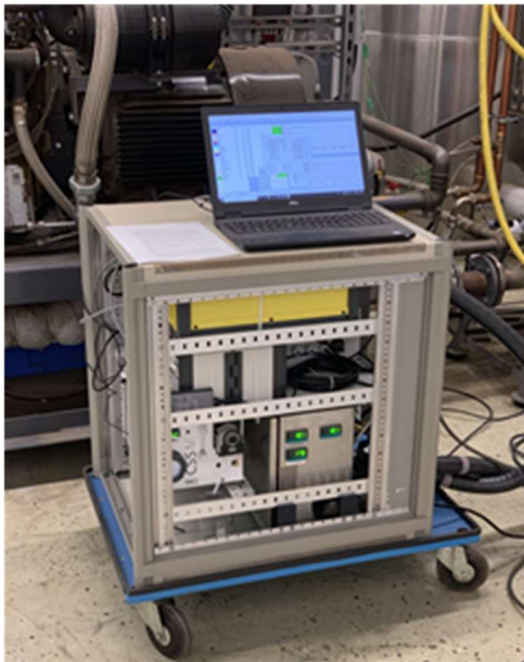
Abb. 2-22 Messwagen mit FTIR im TCV
