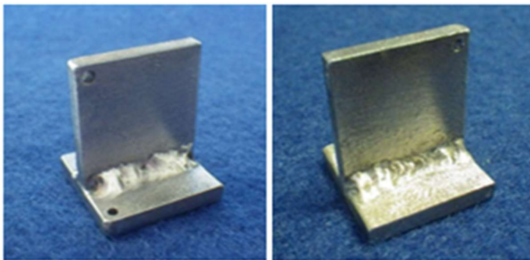
Abb. 2-46 Baustahl-Kehlnahtprobe vor und nach dem Zyklertest
