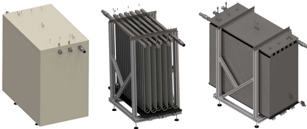
Abb. 2-51 Konstruierter PCM-Speicherdemonstrator; LINKS: Ständerwerk, WÜ, Behälter, Deckblech und Isolierung; MITTE: nur Ständerwerk und WÜ; RECHTS: ohne Isolierung
