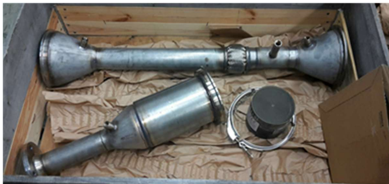
Abb. 2-69 Doppel-Kat-System mit Zwischenluftereindüsung bei Anlieferung
