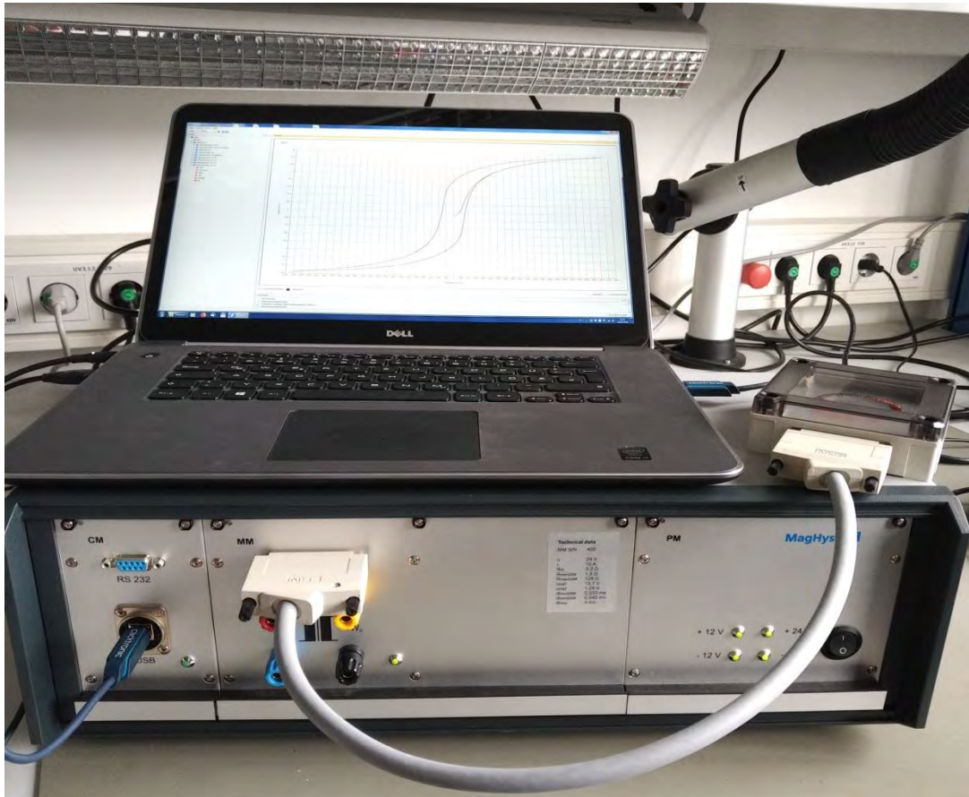
Abb. 4-24: Messplatz auf der Basis von MagHyst
