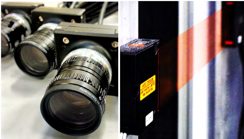
Abb. 4-14: Kompaktes Mehrkammersystem für den Einsatz in Forschung und Industrie (links), Lasersensoren für Trübungs- und Objektmessungen (rechts)
