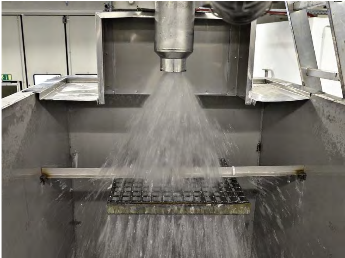
Abb. 4-7: Korrosionsuntersuchungen an verzinkten Metallteilen in einem simulierten Leckstrahl
