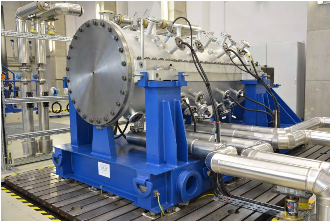
Abb. 4-20: Magnet- und Fanglagerprüfstand MFLP im Zittauer Kraftwerkslabor
