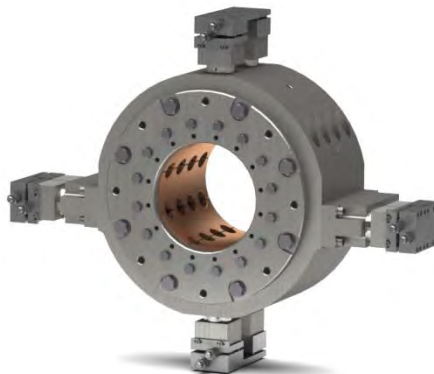
Abb. 4-16: Gleitfanglager für Untersuchungen am Versuchsstand MFLP
