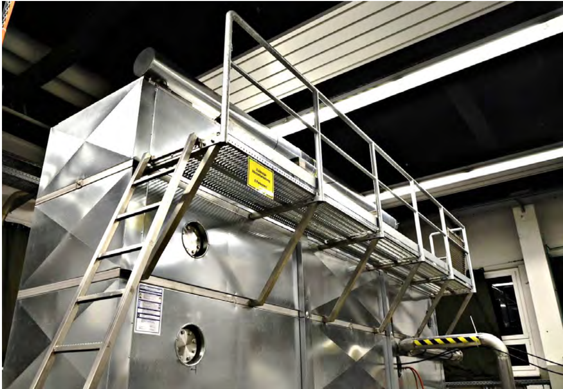
Abb. 4-6: Der Wannenbehälter der Zittauer Strömungswanne (ZSW)
