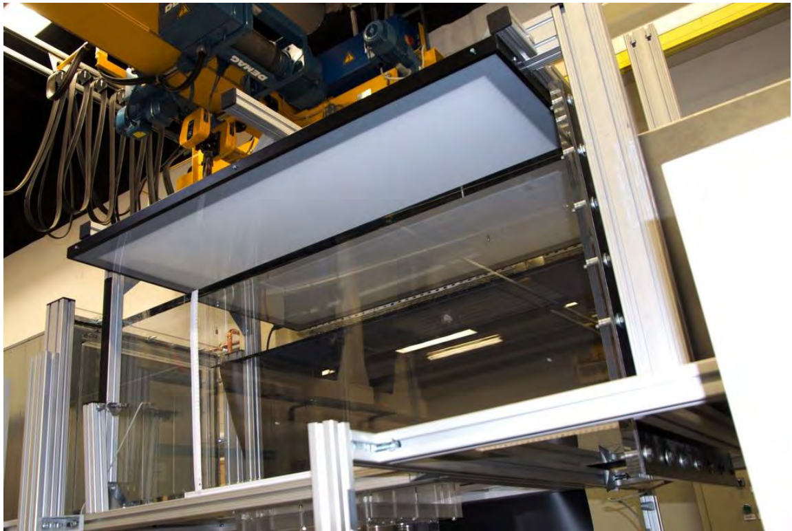
Abb. 4-9: Der Plexiglas-Strömungskanal des Versuchsstands DVABEG
