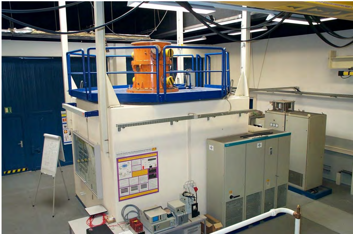
Abb. 4-21: Magnet- und Fanglagerprüfstand FLP 500
